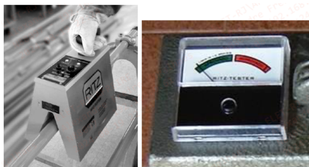
Figura 1: Exemplo do Testador Portátil e indicação de "Aprovado – Reprovado"
