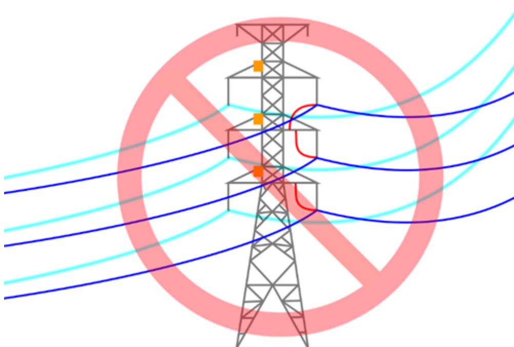
Figura 9: Exemplo de Aterramentos proibido em LT de circuito duplo
